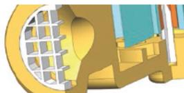
Ситечко на входе водомера, защищающее от проникновения загрязнений в измерительный механизм.
