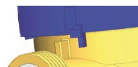
Блокировка вращения счетного механизма, при вращение под углом более 360°.
