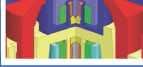
Очень высокая устойчивость к разрыву магнитной муфты, достигающаяся благодаря соответствующему расстоянию между передними поверхностями магнитной муфты.
