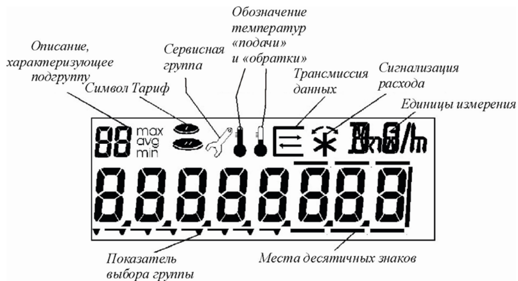
Рисунок 17. Схема дисплея вычислителя теплосчетчика
